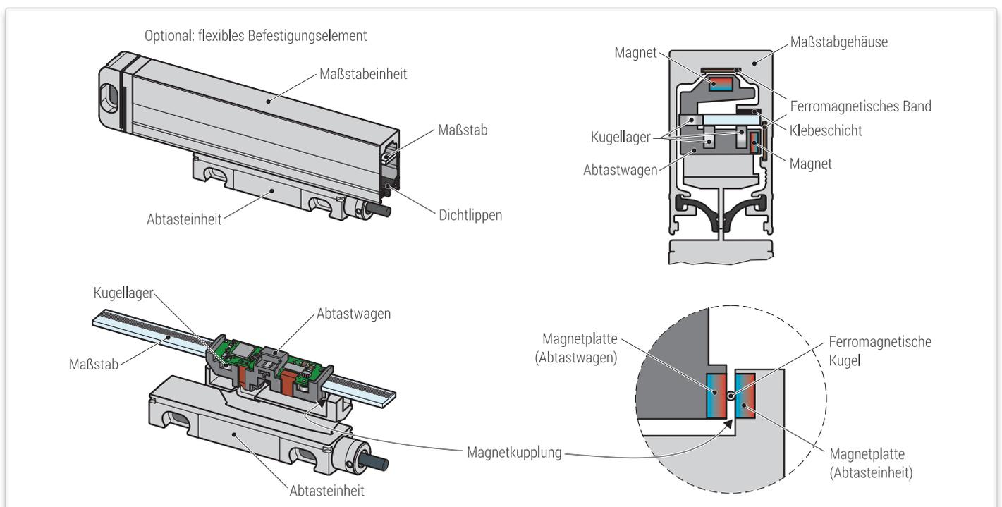
Als Maßverkörperung kommt jeweils eine hochgenaue Strichgitterteilung zum Einsatz. Je nach Gerätetyp wird als Trägermaterial Glas ( $\alpha \approx 8,5 \times 10^{-6}/K$ ) oder Glaskeramik ( $\alpha \approx 0 \times 10^{-6}/K$ ) verwendet.
