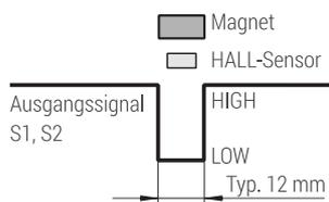
Werkseitig befinden sich die Schaltmagnete je am Anfang (S1) und am Ende (S2) der Messlänge. Sie sind kundenseitig verschiebbar.
