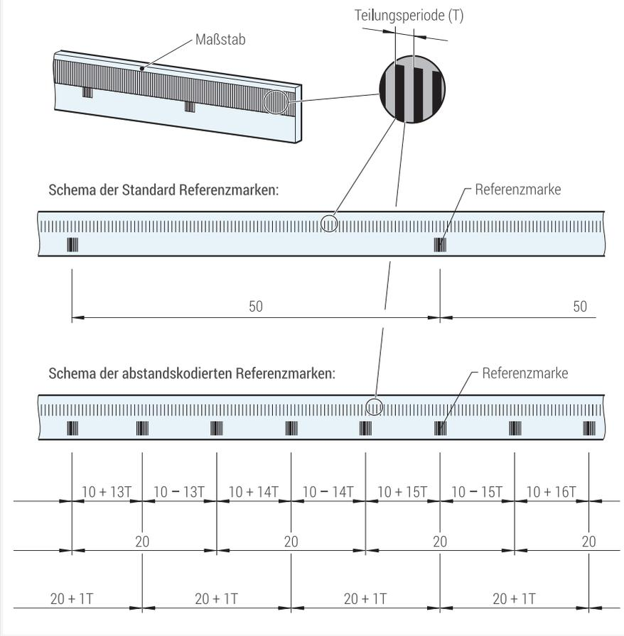
Diese Längenmessgeräte arbeiten nach einem photoelektrischen Messprinzip mit einer **Einfeldabtastung** im Durchlicht.
