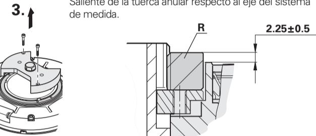
**Stirnseitige Wellenankopplung** (mit mechanischem Fehlerausschluss)
