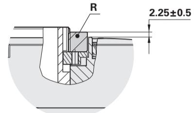
**Stirnseitige Wellenkopplung** (mit mechanischem Fehlerausschluss)
