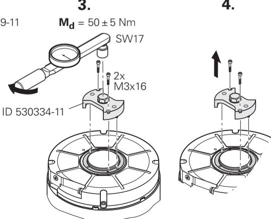
**Stirnseitige Wellenkopplung** (ohne mechanischen Fehlerausschluss)
