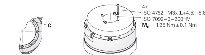
Wellenkopplung mit Ringmutter [R] (ohne mechanischen Fehlerausschluss)
