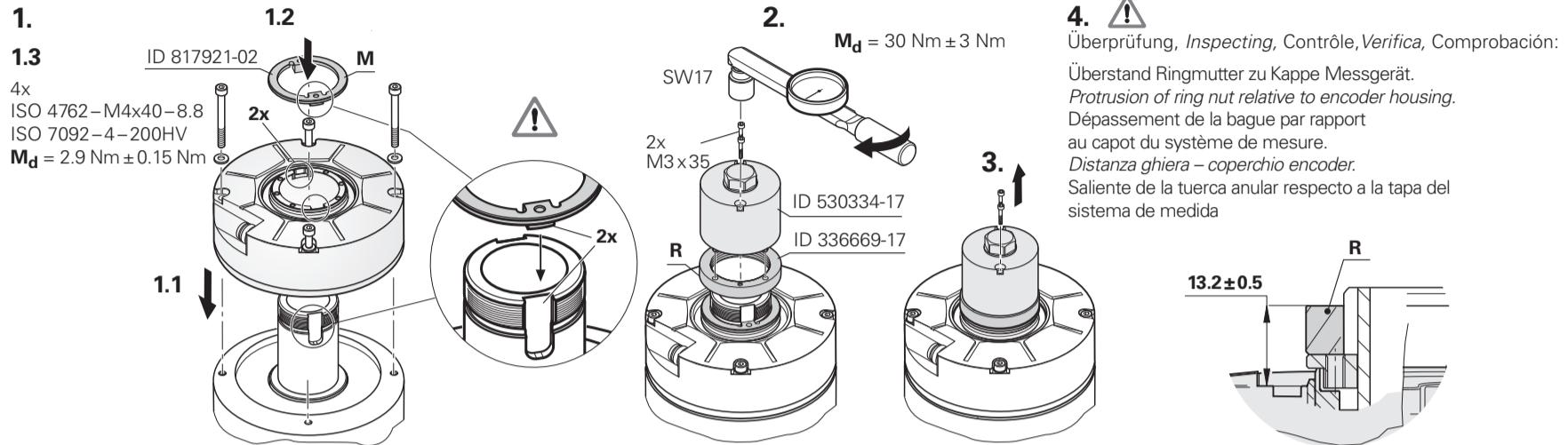
Stirnseitige Wellenkopplung (mit mechanischem Fehlerausschluss)
