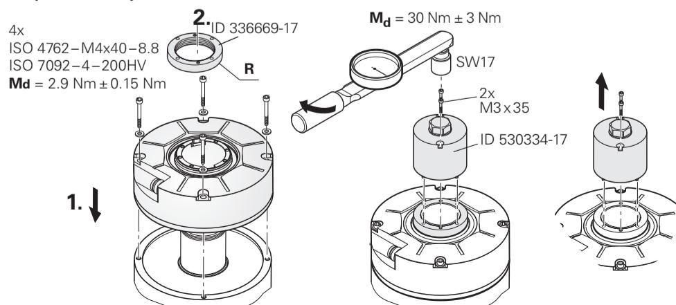
Stirnseitige Wellenkopplung (ohne mechanischen Fehlerausschluss)
