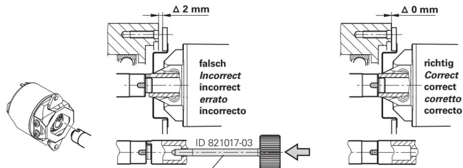
Montagehilfe zum Verdrehen der Geberwelle für die formschlüssige Verbindung.
