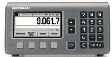
Die Auswerte-Elektronik ND 280 für eine Achse eignet sich für Mess- und Prüfplätze, aber auch für einfache Positionieraufgaben. Der universell aufgebaute Messgeräte-Eingang erlaubt den Anschluss aller inkrementalen Messgeräte mit  $11\text{-}\mu\text{A}_{SS}$ - und  $1\text{-V}_{SS}$ -Signalen und der absoluten Messgeräte mit EnDat-2.2-Schnittstelle von HEIDENHAIN.
