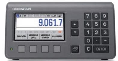
Die Auswerte-Elektronik ND 287 für eine Achse ist aufgrund ihres Funktionsumfangs prädestiniert für Mess- und Prüfplätze, aber auch für einfache Positionieraufgaben. Der universell aufgebaute Messgeräte-Eingang erlaubt den Anschluss aller inkrementalen Messgeräte mit  $11\text{-}\mu\text{A}_{SS}$ - und  $1\text{-V}_{SS}$ -Signalen und der absoluten Messgeräte mit EnDat-2.2-Schnittstelle von HEIDENHAIN.
