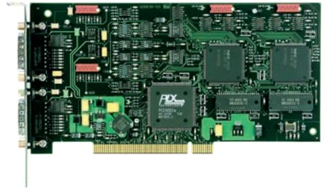
Der Signalkonverter IK 220 ist eine Auswertelektronik für zwei Achsen. In Ausführung einer PC-Zählerkarte kann der IK 220 direkt in einen freien PCI-Steckplatz des Computers gesteckt werden.
