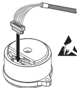
Auxiliar de montagem para inserir e retirar o conector de placas de modo a evitar danos nos cabos. A força de extração deve ser aplicada somente na caixa da tomada e não nos condutores.
