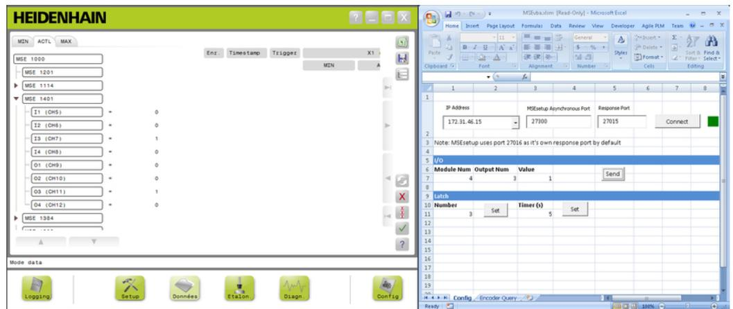
L'exemple suivant consiste à définir la sortie relais du module 3 sur "high" avec le fichier MSEvba.xlsm.
