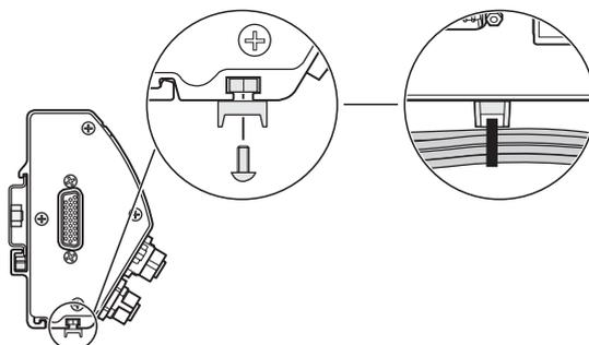
Tous les modules sont livrés avec un kit d'éléments de fixation servant à guider les câbles. Chaque kit comprend deux jeux d'éléments de fixation.
